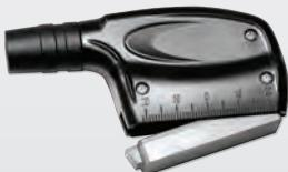
Конструкция антенных решеток допускает замену АМ по мере истирания его рабочей поверхности. Пользователь имеет возможность самостоятельной замены изношенного АМ АР, что позволяет проводить УЗ контроль практически без остановки, повышая его производительность. Существует возможность притирки сменного АМ под различные диаметры труб, что существенно расширяет спектр решаемых задач ультразвукового контроля.
